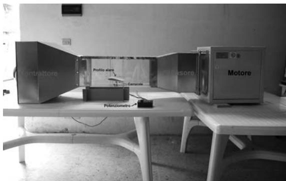
Illustreremo ora alcuni dei calcoli svolti nelle stesura del progetto. I valori di velocità del vento all'interno della galleria, ove non specificato diversamente, sono stati sempre rilevati grazie ai tre fori presenti sul contrattore, inserendo l'anemometro all'interno di essi, a tre profondità diverse e prestabilite, ottenendo nove valori di velocità. Nella tabella al fondo della pagina 100 sono racchiusi i valori standard utilizzati durante i calcoli.
