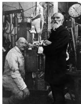
Heike Kamerlingh Onnes (a sinistra) e Van der Waals davanti all'apparato per la liquefazione dell'elio
