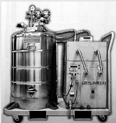
Liquefattore automatico di elio per utilizzo di laboratorio. È un prodotto industriale, trasportabile su un carrellino, arriva a produrre 18 litri al giorno di liquido. Il gas, dato il costo dell'elio, dopo l'evaporazione viene riciclato e nuovamente liquefatto.
