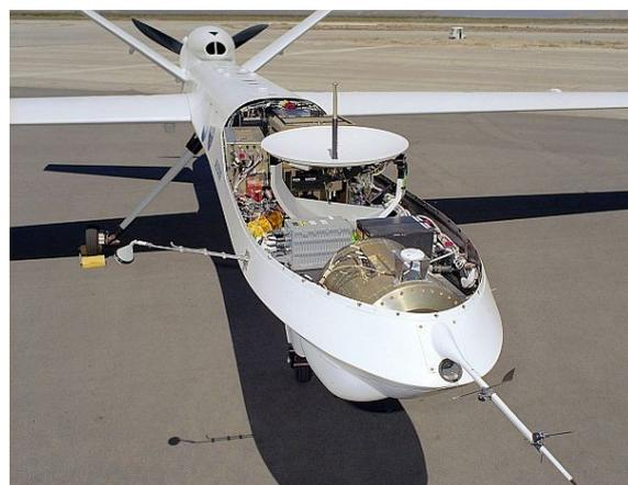
Sistemazione interna di parte della strumentazione nel prototipo del Reaper (Usa, 2004)
