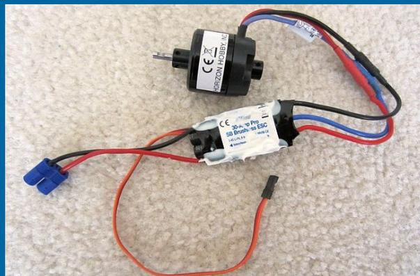
Tipico ESC collegato a un motore elettrico brushless (al connettore blu viene connessa la batteria, all'altro connettore la ricevente del radiocomando)
