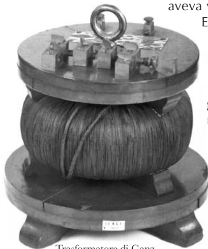
Trasformatore di Ganz
