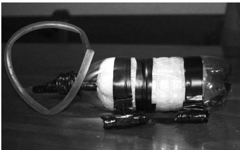
anche quella dell'acqua) risucchiando aria dal cielo. Il volume aumenta nuovamente e il sommergibile esce in emersione. In questo caso quindi il corpo varia il suo assetto variando il proprio volume. Lo stesso principio è utilizzato dai pesci, che modificano il proprio volume mediante l'uso della vescica natatoria.
