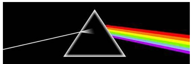
Rappresentazione schematica della dispersione della luce da parte di un prisma
