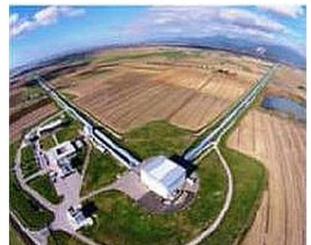
*Figura 3: LIGO=Laser Interferometer Gravitational-Wave Observatory. I due interferometri negli Stati Uniti uno ad ovest, Hanford, (Washington), H1, l'altro ad est, Livingston (Louisiana), L1, con bracci perpendicolari di 4 km. Il tempo di percorrenza della distanza fra i due, per un segnale che viaggia alla velocità della luce, è di circa 10 ms [Zendri, 2016].*
