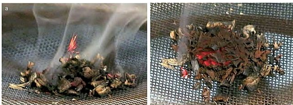
Il test di combustione con frammenti di legno e biossido di manganese
