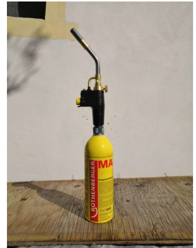
Bruciatore utilizzato, composto da un cannello e un adattatore che consente il collegamento alla bombola di Mapp
