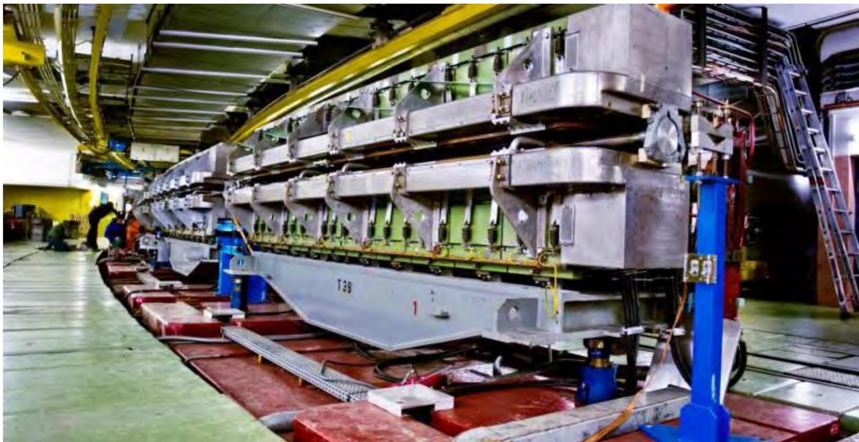
Foto del ProtoSincrotrone (CERN) del CERN (in primo piano un magnete dipolo)
