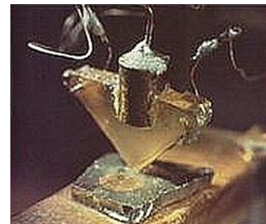
Il transistor a contatto (a baffo di gatto) realizzato nel 1947 da Bardeen e Brattain (Bell Labs)
